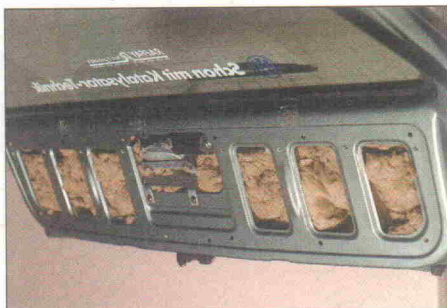
Beim Polo darf es etwas mehr sein. Nicht nur die Heckklappe wird bedämpft (oben), auch hinter den Radkästen darf gestopft werden (unten).
