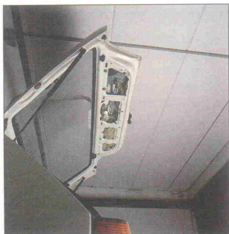
Die Heckklappe des Golf erhält eine Ladung Steinwolle. Auf das Scheibenwischergestänge sollte man jedoch Rücksicht nehmen.
